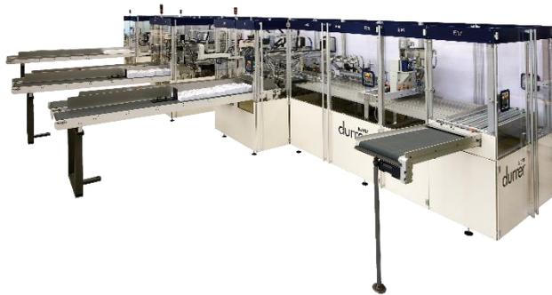
Die BLOFIX ist eine vollautomatische Verarbeitungs-linie zum Aufkleben von Kalenderblöcken auf eine Kartonrückwand und zum Befestigen von Kopflaschen am Kalender.
