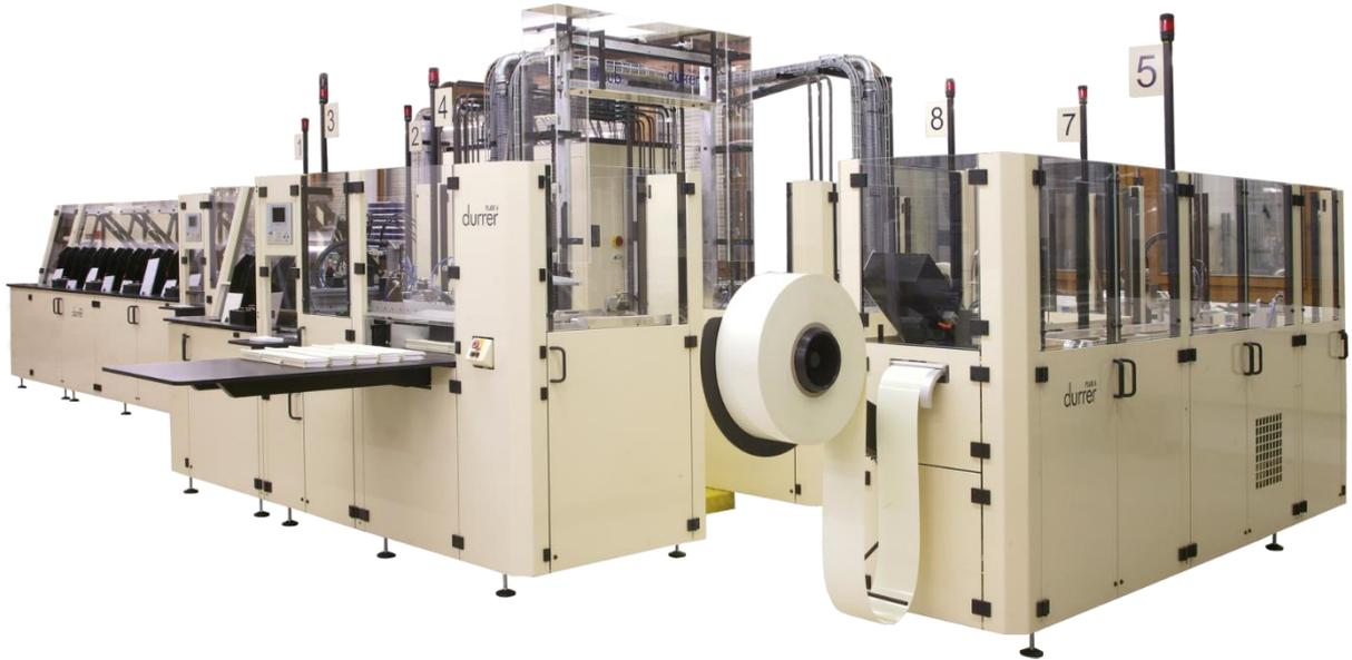
Die PLABI 6 stellt Kunststoffkammbinder her, inklusive Vorverarbeitung des Buchblockes und bindet diesen vollautomatisch. Sie besteht aus mehreren Basismodulen und kann kundenspezifisch ausgelegt werden.
