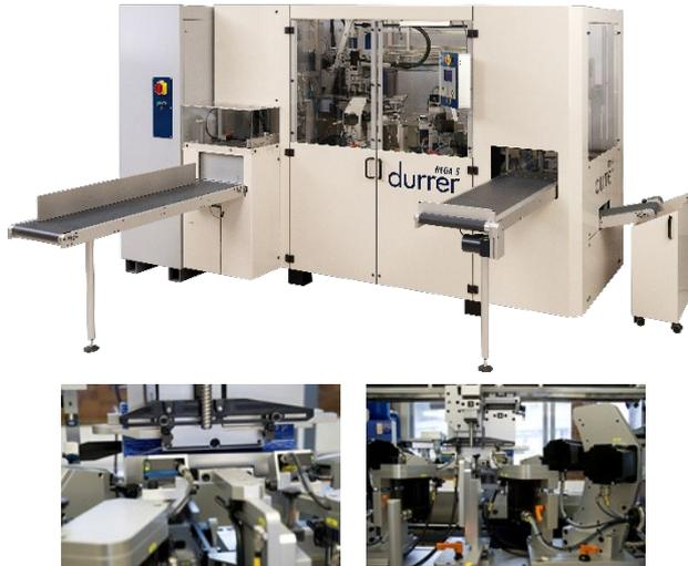
Die REGA 5 verarbeitet Produkte im Formatbereich A4 – A5. Sie zeichnet sich aus durch hohe Flexibilität, kurze Umrüstzeiten und einfache Menüführung.
