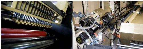
Die REGA 4 verarbeitet Produkte im Formatbereich A4 – A6. Sie zeichnet sich aus durch hohe Flexibilität, kurze Umrüstzeiten und einfache Menüführung.
